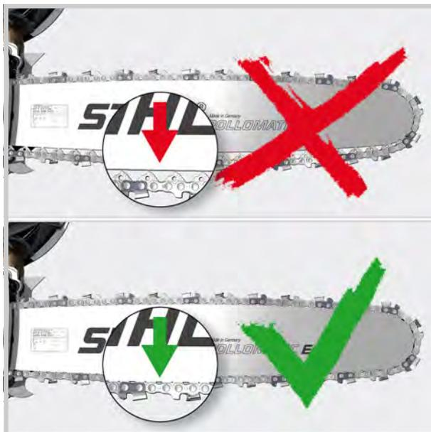
Lorsque la chaîne est tendue correctement, elle doit porter sur toute la longueur du guide-chaîne et, lorsque le frein de chaîne est desserré, il doit être possible de la faire glisser librement sur le guide-chaîne.
