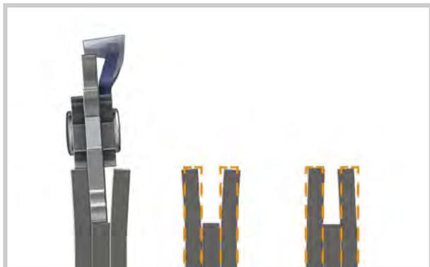
**Défaut** Effet mécanique externe, par ex. en cas de coincement du guide-chaîne
