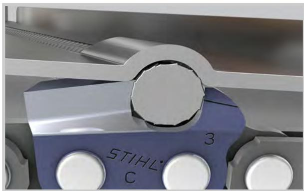
Un appui correct du porte-lime sur le sommet de la gouge et sur le limiteur de profondeur garantit la tenue de la lime à la hauteur correcte et le respect de l'angle de front prescrit. Avec une marque bien visible indiquant l'angle de 30°, le porte-lime aide également à respecter l'angle d'affûtage.
