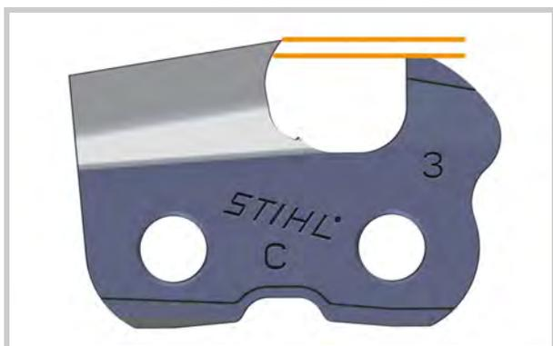
Par retrait du limiteur de profondeur on entend la différence de hauteur entre le bord supérieur du limiteur de profondeur et l'arête avant du sommet de la gouge.
