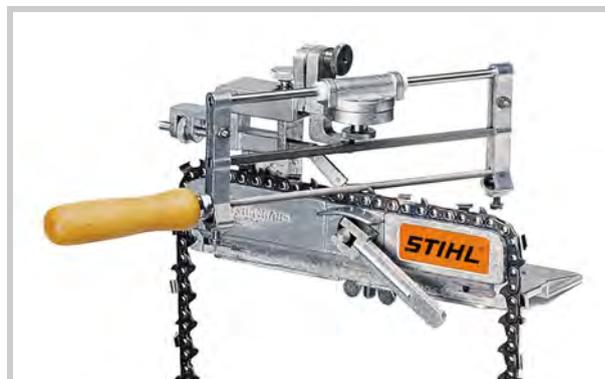
Le FG 2 se monte sur l'établi. Pour affûter la chaîne, il est nécessaire de la démonter du guide-chaîne.
