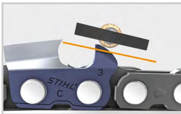
Après cela, rectifier le haut du limiteur de profondeur en biais, parallèlement au repère de maintenance – en veillant à ne pas raccourcir davantage le sommet du limiteur de profondeur.
