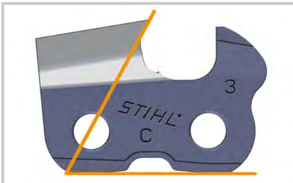
Pour obtenir un fonctionnement régulier et le rendement de coupe optimal de la chaîne, il faut que toutes les gouges aient la même longueur et que l'angle d'affûtage soit correct.
